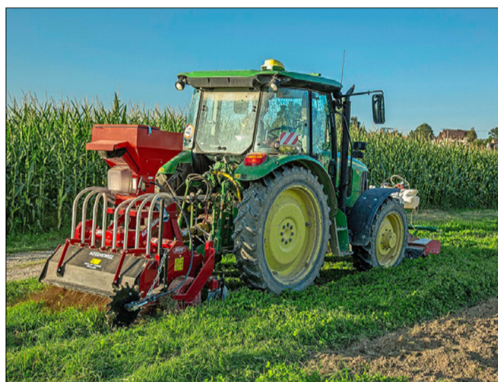
Der Geohobel ist das wichtigste Bodenbearbeitungsgerät in allen Nicht-Dammkulturen auf dem Betrieb. (Bild: zvg)
